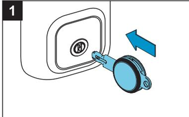
1 Schlüssel in den Zylinder stecken.
